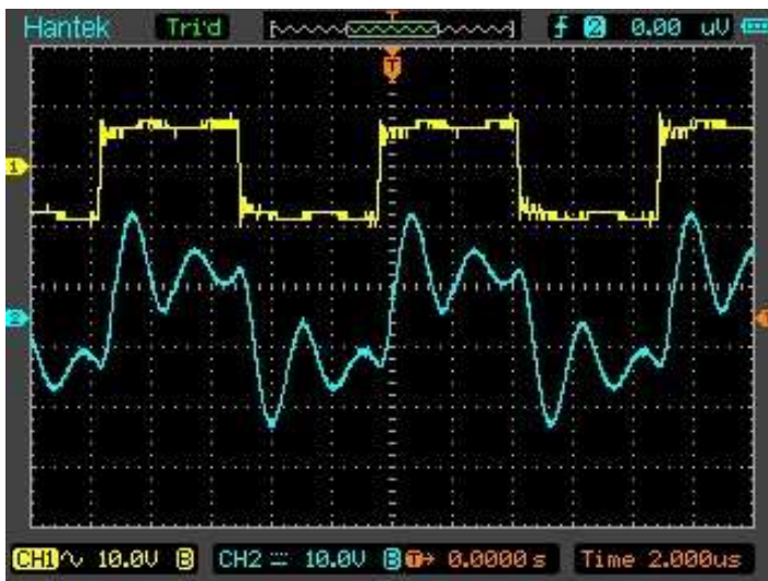
Fig.2. Paso de un pulso de 106 kHz a través del transformador Murata 1002C excitando un MOSFET de 50A.
