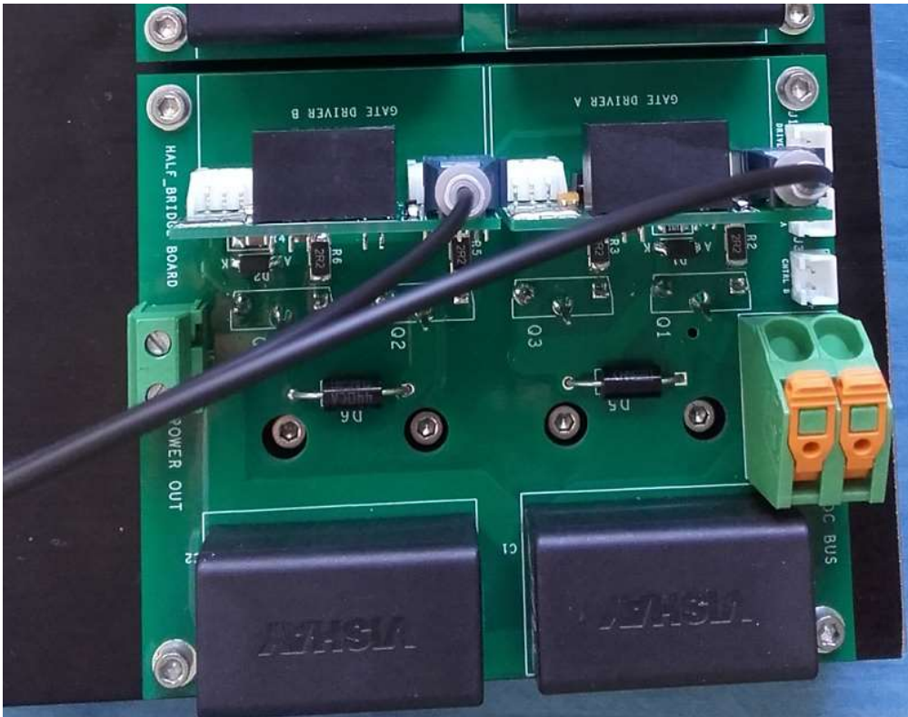
Fig.8. Ejemplo de aplicación en un puente H de 10 KW fabricado por ledoelectronics.
