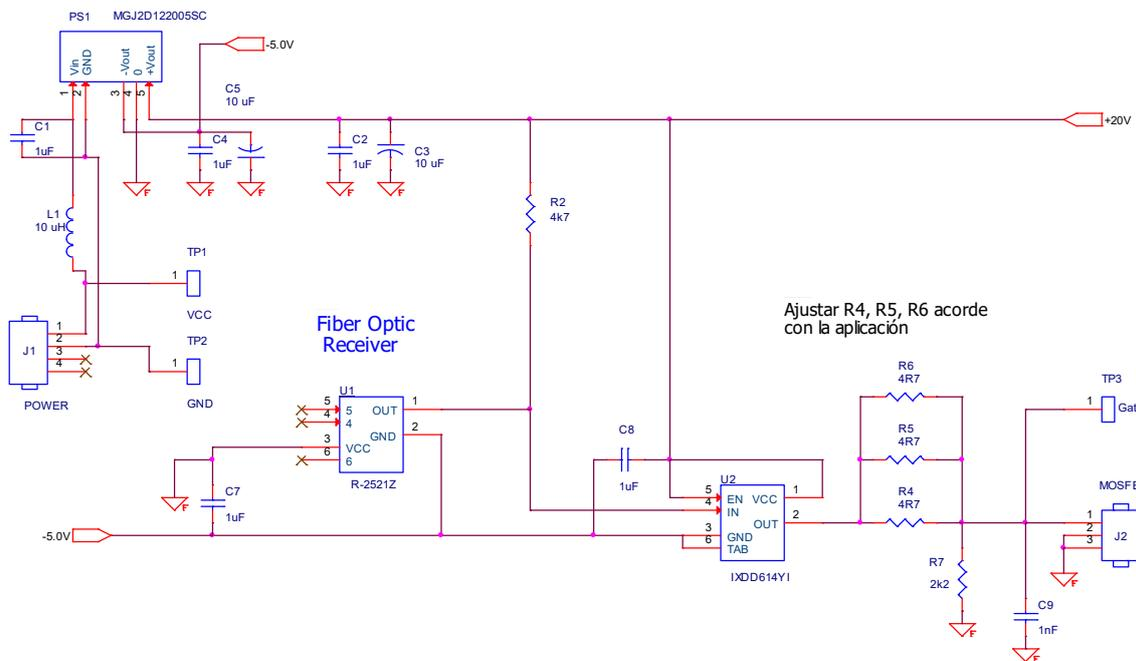
Fig.1. Esquema eléctrico del amplificador de compuerta inversor le-F2N20-14.
