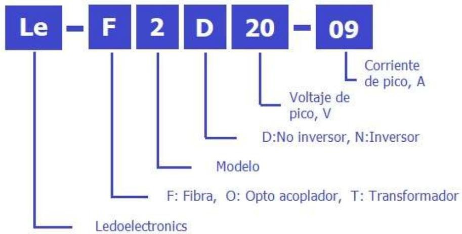
Fig.5. Estructura del nombre de los componentes de la serie.
