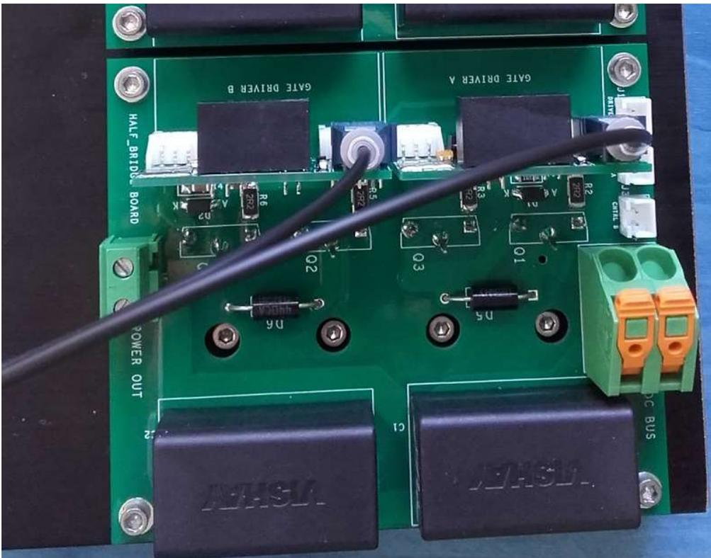
Fig.7. Ejemplo de aplicación en un puente H de 10 KW fabricado por ledoelectronics.
