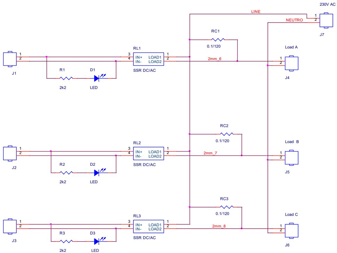
La amplitud de la señal de control debe estar entre 3V y 32V DC, con un consumo menor de 10 mA, por lo que estas pueden ser controladas directamente desde los pines de cualquier microcontrolador.
