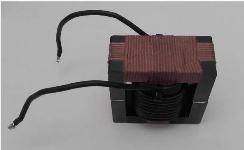
Fig.2. Imagen del inductor construido acorde con los cálculos.
