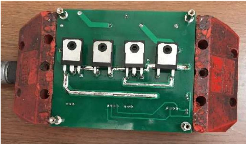
En la fig.3 se muestra la conexión del transformador de alta frecuencia, y todo el circuito correspondiente al rectificador de la parte secundaria.
