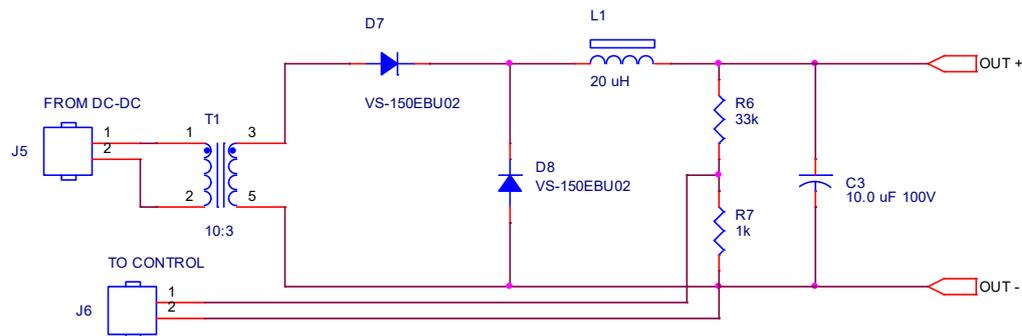
Fig.4. Transformador y rectificador de salida
