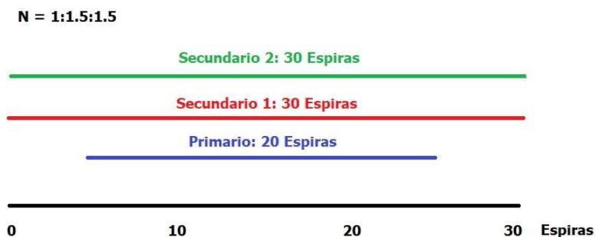
Fig.4. Bobinado trifilar de un transformador de pulsos.
