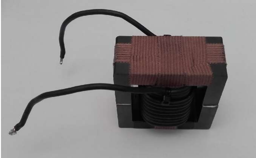
Fig.1.7. Imagen del inductor construido acorde con los cálculos.
