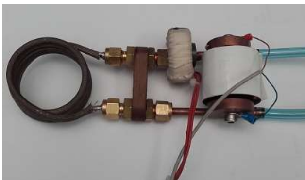
Fig.2. Transformador y tanque LC.
