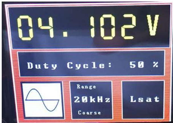
Fig.16. Representación automática en pantalla, del voltaje de la fuente de alimentación.
