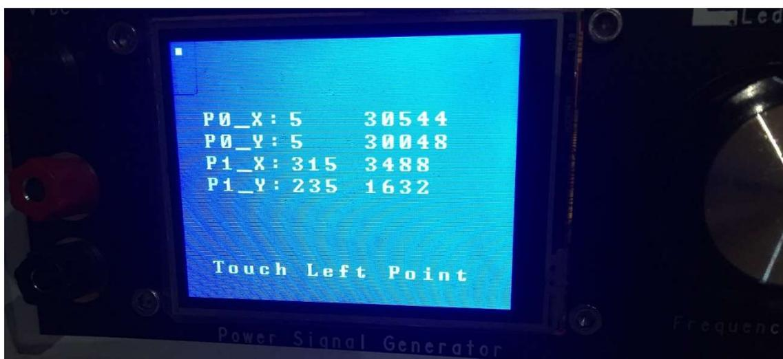
La calibración se realiza pulsando con precisión primero sobre el punto de la izquierda, y luego sobre el punto que aparecerá a la derecha en la parte inferior.
