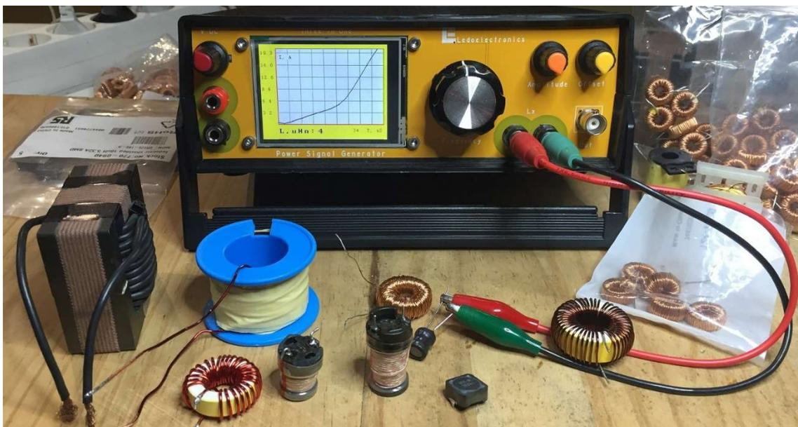
Este módulo es una novedad, y permite no solo medir la inductancia de un inductor, sino también su comportamiento a diferentes corrientes, lo que es de vital importancia, ya que podemos determinar la corriente de saturación del núcleo. La corriente máxima de chequeo es de 24 A de pico.
