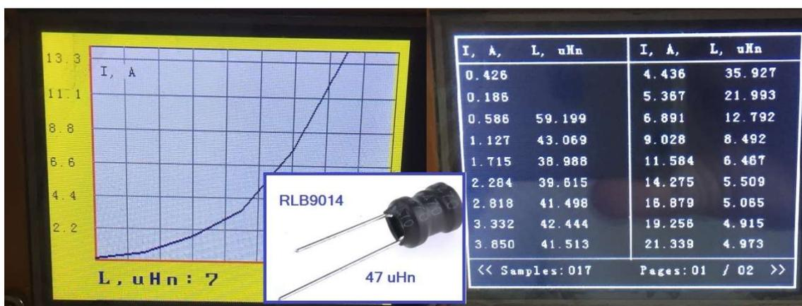
Fig.12. Medición del inductor RLB9014 de Bourns a una corriente máxima de 10 A.
