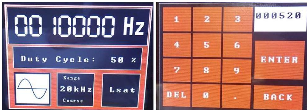
Fig.3. Fijación de una frecuencia concreta, usando el teclado.
