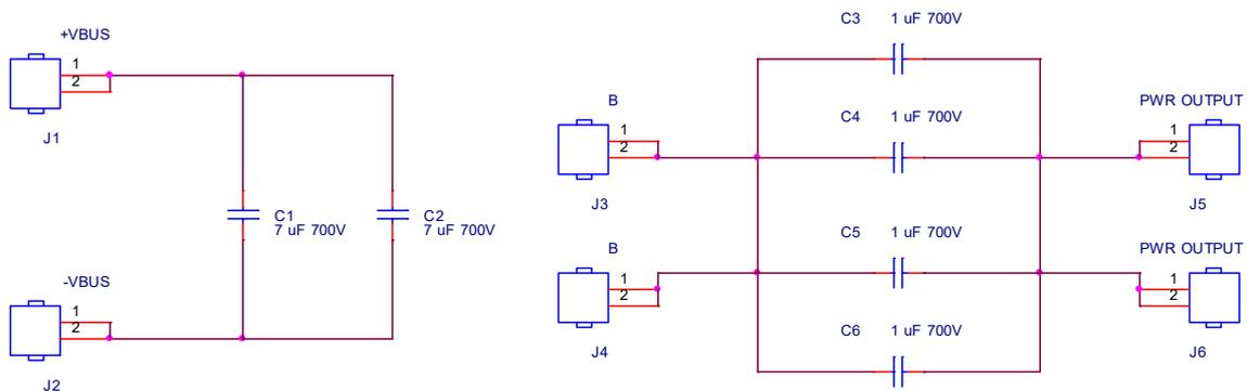
Se debe minimizar todo lo posible la longitud de los cables de conexión con el bus de DC del inversor (J1 y J2) para disminuir la inductancia parásita.
