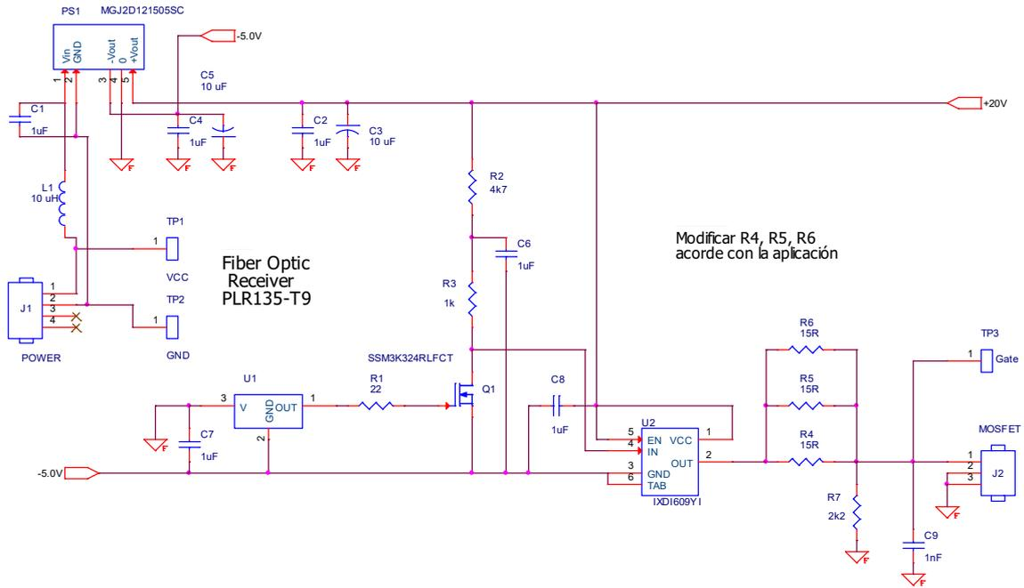
Fig.1. Esquema eléctrico del amplificador de compuerta no inversor Le-F1J15-09.
